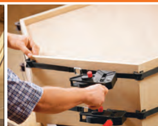
Serraggi con angolo da 60° a 180°
