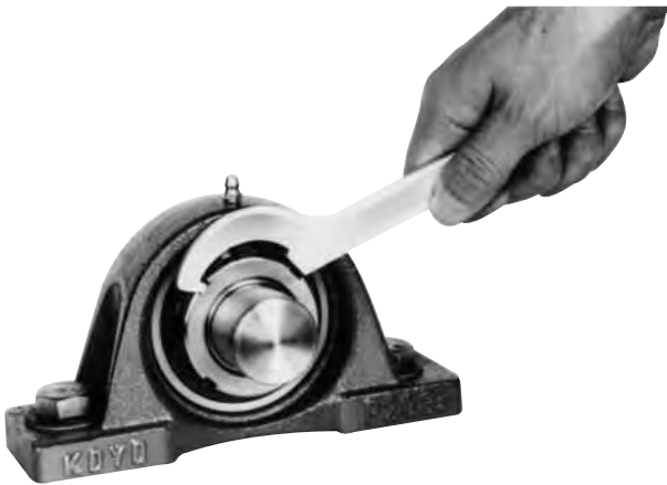
Fig. 14.7 Serraggio della ghiera
