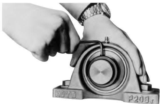
Fig. 14.5 Serraggio del grano di bloccaggio
