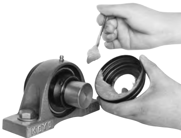
Fig. 14.11 Ingrassaggio dello spazio interno e del labbro di tenuta del coperchio
