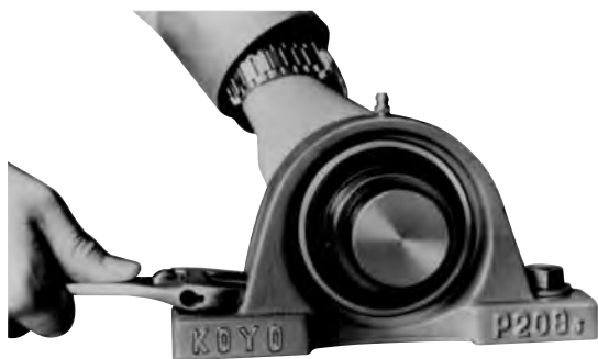
Fig. 14.4 Fissaggio del supporto alla base
