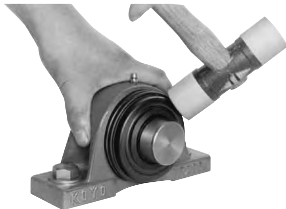
Fig. 14.12 Installazione del coperchio in acciaio stampato
