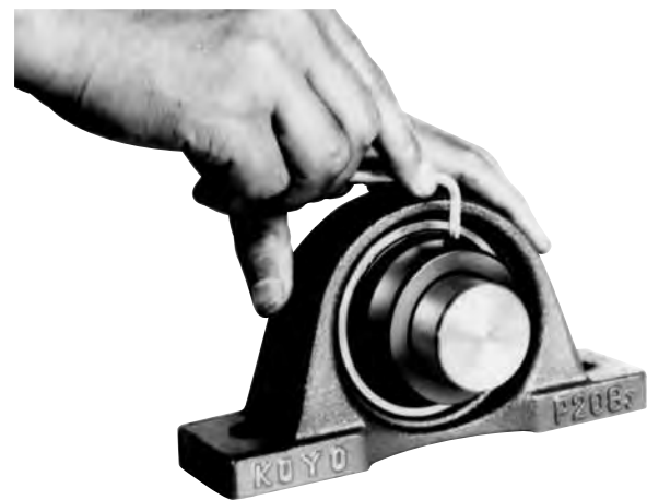
Fig. 14.10 Installazione del collare eccentrico autobloccante
